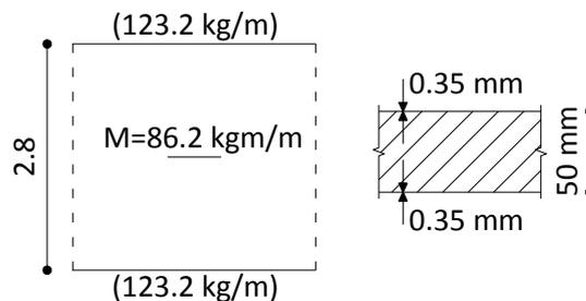
El isopanel, de 10 cm de espesor, consiste en dos chapas de acero de espesor 0.35 mm entre las cuales hay un relleno de poliuretano. Considerando únicamente el aporte del acero para resistir los esfuerzos, el momento máximo resistente es:
