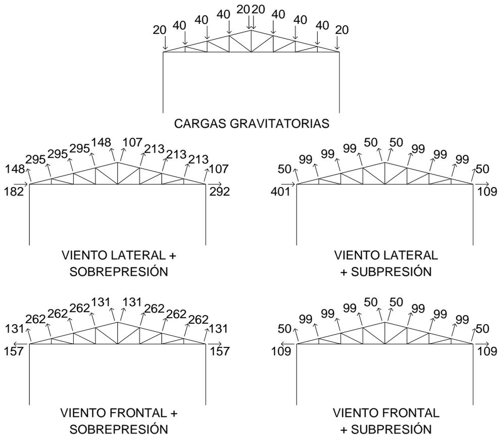
Se considera que las uniones pilar – platea y pilar – cercha no son capaces de transmitir momentos, por lo que para evitar que la estructura se comporte como un mecanismo se verifica que los muros de isopanel son capaces de transmitir las cargas horizontales a la cimentación. Por lo tanto, se analiza únicamente la cercha sometida a cargas verticales.
